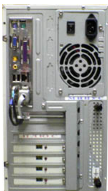
Рисунок А.2 - Вид сзади форм-фактор АТХ. (в последних версиях разъем RS-232 отсутствует)
